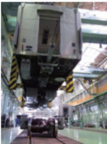
載せ替え作業は、天井に設置された 28 トンクレーンで車両の前後 2カ所をつかみ、非常にゆっくりした速度で車両を持ち上げます。次に台車の上まで横移動した後、静止させ、ゆっくりした速度で徐々に車両を下していきます。ある程度、車両と台車が接近したところで、責任者より「待て！」の指示が。そこから検査作業員が責任者に報告をして、責任者がクレーンオペレーターに指示を出します。「渋谷下げ～！」、「吉祥寺下げ～！」構内では、車両を前後で呼ぶのではなく、進行方向となる「渋谷」、「吉祥寺」の名称で指示が出されます。今回の載せ替え作業となる車両はパンタグラフ付の動力車なので、接続にはさらに慎重を期します。作業開始から約 10 分後、渋谷側、吉祥寺側両方の台車に車両がガッチリと固定され、終了となりました。
